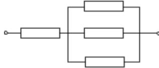
6. До ділянки кола з чотирьох однакових резисторів на ідеального вольтметра прикладено напругу 100 В. Визначте показання вольтметра. (80 В)
